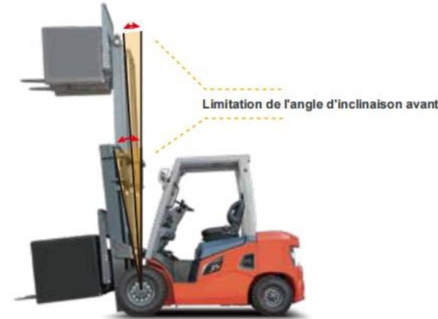
**Fonction de contrôle de la vitesse du mât** : lors du travail en hauteur, la vitesse d'inclinaison arrière du mât est contrôlée intelligemment, et les extrémités avant et arrière de l'inclinaison sont amorties intelligemment pour maintenir la stabilité pendant les opérations en haute altitude.
