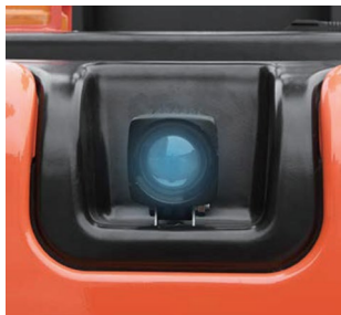
Projecteur LED bleu de sécurité de série
