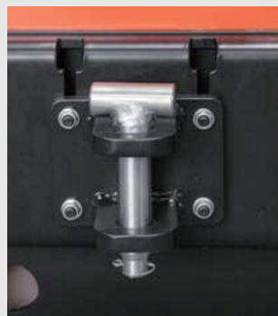
Attelage pour traction chariots, remorques ou plateaux roulants (en option)
